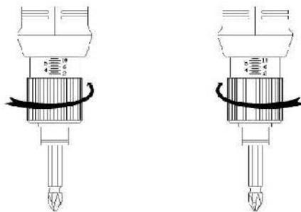
E' possibile bloccare la ghiera tramite un coprifrizione (venduto separatamente). Per posizionarlo correttamente, è necessario togliere l'anello di fermo #2, svitare la ghiera di regolazione #3, svitare e togliere l'anello frontale #1 e sostituirlo con il copri frizione #35.
