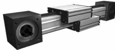
Standardlänge Führungsschlitten - siehe Tabelle. Auf Anfrage kann der Schlitten in beliebiger Länge gefertigt werden, wobei sich beim Verlängern des Schlittens die Belastungsmomente erhöhen.
